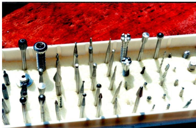
Рис. 10. Микроинструменты для прецизионного машиностроения, приборостроения и микроэлектронной промышленности.
